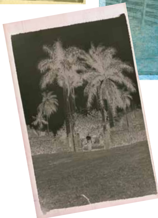
Negativos em acetato de celulose apresentando deterioração na base
