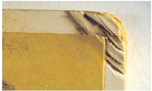
Amassamento da borda e delaminação do suporte secundário
