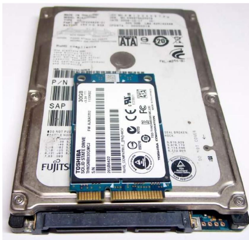
**Figura 100.** Um SSD mSATA Toshiba de 30GB em cima de um HDD interno de notebook de 2,5 polegadas Fujitsu de 320GB.
